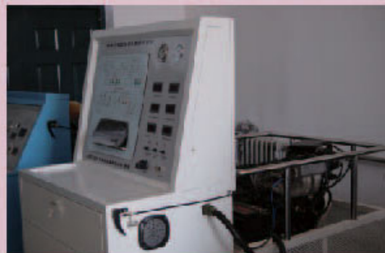
电控发动机性能测试实验台
